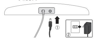
コントローラーの電源スイッチをONにすると電源 ランプが点灯し、振動が開始されます(電源投入時の モードは「リラックス」です)。
