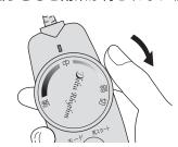
※使用後、電源スイッチを「切」にしなくても、30分 経つと"オートOFF機能"により、自動的に電源 スイッチが「切」になります。
