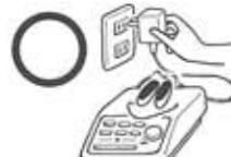
使用後は、機器本体の電源スイッチを切ってから、電源プラグを抜いてください。
