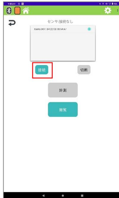
3. 接続が完了すると、Bluetooth 接続を示すアイコンが接続中のものに変化し、センサー：接続中と表示されます。加えてセンサーのバッテリー残量が表示されます。一度接続したセンサーがある場合、次回以降はアプリを起動すると自動的に、最後に接続されたセンサーへ接続されます。
